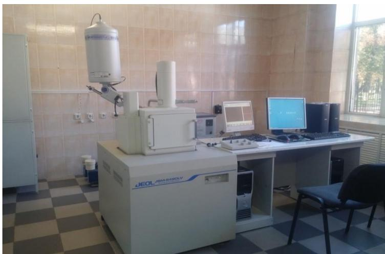
Сурет 2. JSM-6490LV расторлы төменвакуумды электронды микроскоп
